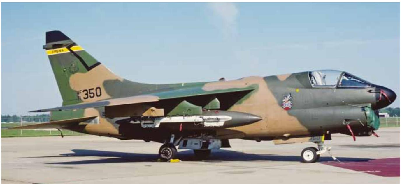
Das Leitwerkband der 71-0350 der 149th TFS war in Gelb mit weißen Rändern und dem schwarzen Schriftzug „Virginia“ aufgebracht. Die Maschine trägt zwei MAU-41 MER (Multiple Ejector Racks).
